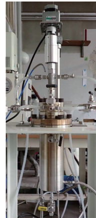
図：(左) 流体岩石反応実験に使用する攪拌式水熱反応容器（東北大学設置）。(右) 化学的処理による粘土鉱物の変質実験結果。変質に伴い結晶構造が変化する様子が見られる。
