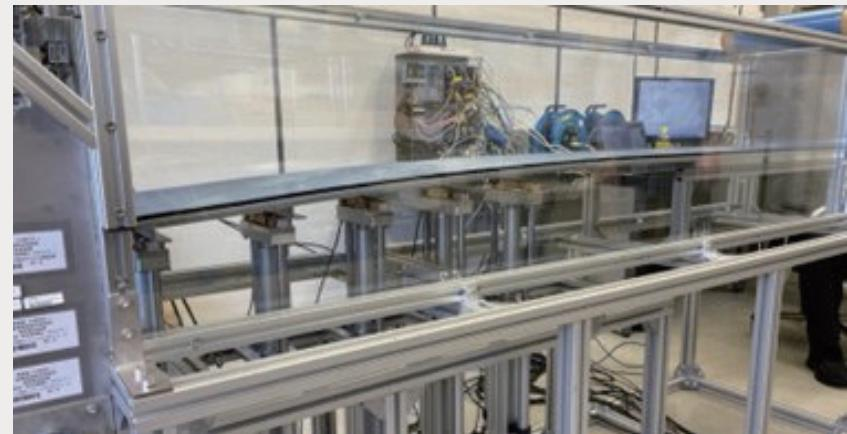
図1:実験装置の写真。電動シリンダの上下動により底板の高さが変わる。
