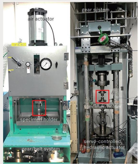
写真：左：中—高速摩擦試験機 右：超低速—低速摩擦試験
